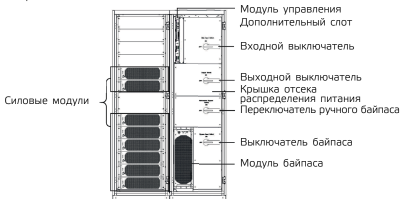
Рис. 1-9 Структура ИБП 400 кВА (полная конфигурация)
