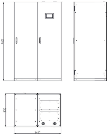
Рис. 2-3 Размеры шкафа ИБП 600 кВА (единица измерения: мм)
